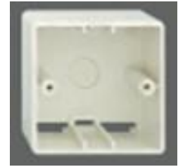
UAE - ApG 135 105 03 Aufputzgehäuse; Unterputz-Einbaudose; weiß (ähnlich RAL 1013) 81x81x46mm; 93 g
